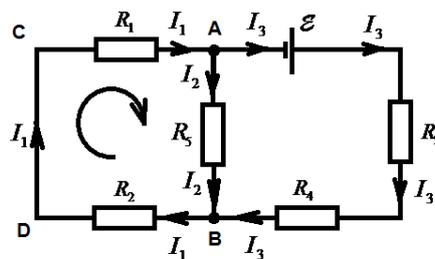
Падение напряжения происходит на элементах, обладающих сопротивлением. Для рассматриваемого контура  $ABDC$  этими элементами являются сопротивления  $R_1$ ,  $R_2$  и  $R_5$ . Отметим, что падения напряжений на этих сопротивлениях мы будем считать положительными, поскольку направление тока через них совпадает с выбранным нами направлением обхода.
