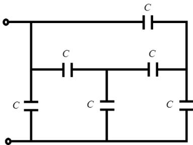
6. Определите заряд каждого из конденсаторов, если  $C_1 = C_2 = C_3 = 30$  пФ,  $C_4 = 120$  пФ, а к точкам А и В подведено постоянное напряжение  $U = 200$  В.
