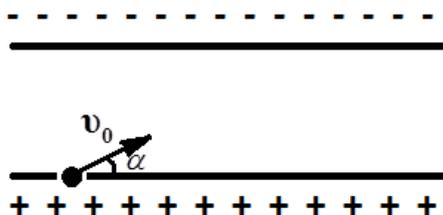
13. В плоский воздушный конденсатор влетает электрон с энергией  $W = 2000 \text{ эВ}$  под углом  $\alpha = 15^\circ$  к плоскости пластин. Длина конденсатора  $\ell = 10 \text{ см}$ , расстояние между пластинами  $d = 1 \text{ см}$ . Вычислить напряжение, до которого необходимо зарядить конденсатор, чтобы электрон вылетел параллельно его пластинам.
