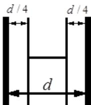
3. Конденсатор состоит из трех полосок фольги, площадью  $6 \text{ см}^2$  каждая, разделенных слоями слюды толщиной  $d = 0,4$  мм. Крайние полоски
