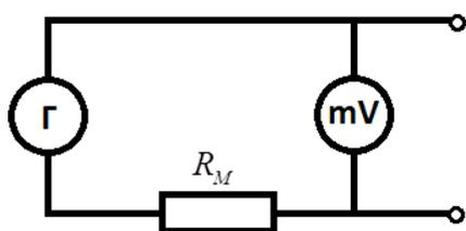
11. Электрическая схема включает в себя милливольтметр, гальванометр и магазин сопротивлений (см. рис.). Известно, что при значении сопротивления магазина  $R_{M1} = 1500 \text{ Ом}$ , милливольтметр показывает напряжение  $U_1 = 40 \text{ мВ}$ , а при значении сопротивления  $R_{M2} = 2500 \text{ Ом}$  - напряжение  $U_2 = 75 \text{ мВ}$ . Вычислите по этим данным ток через гальванометр, если известно, что его значение в обоих случаях одинаково.
