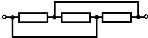
15. Вычислите общее сопротивление цепи, состоящей из одинаковых резисторов  $R_0 = 6 \text{ Ом}$  (см. рис.).
