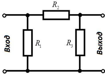
14. Вычислите общее сопротивление цепи, состоящей из одинаковых резисторов  $R_0 = 5 \text{ Ом}$  (см. рис.).
