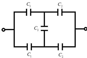
5. Вычислите емкость батареи, состоящей из одинаковых конденсаторов емкостью  $C = 12$  мкФ (см. рис.)
