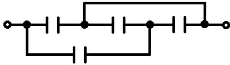
13. Вычислите емкость батареи одинаковых конденсаторов емкостью  $C = 30 \text{ мкФ}$ , изображенной на рис.
