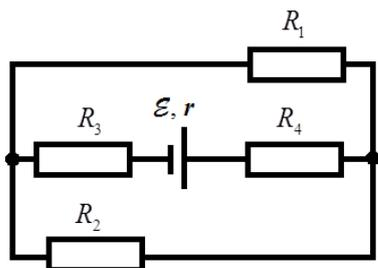
2. В электрической схеме, изображенной на рисунке, значения сопротивлений равны:  $R_1 = 20 \text{ Ом}$ ,  $R_2 = 30 \text{ Ом}$ ,  $R_3 = 5 \text{ Ом}$ ,  $R_4 = 25 \text{ Ом}$ ,  $R_5 = R_6 = 40 \text{ Ом}$ . ЭДС источника составляет  $E = 150 \text{ В}$ . Вычислить значения токов в каждой ветви данной цепи.
