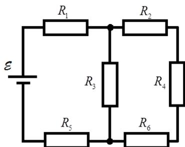
3. В электрической схеме, изображенной на рисунке, значения сопротивлений равны:  $R_1 = 20 \text{ Ом}$ ,  $R_2 = 10 \text{ Ом}$ ,  $R_3 = 25 \text{ Ом}$ ,  $R_4 = 60 \text{ Ом}$ . Определить значение ЭДС источника, если через ветвь цепи, содержащей источник, идет ток  $I = 4 \text{ А}$ .
