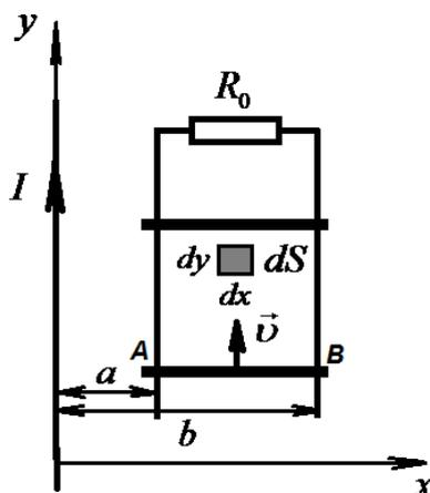
1. Проводник  $AB$  движется в магнитном поле напряженностью  $H$ , создаваемым током  $I$ . Поскольку площадь контура  $AR_0B$  при этом уменьшается, возникает изменение магнитного потока через замкнутый контур. В результате в контуре  $AR_0B$  возникнет Э.Д.С. индукции и потечет индукционный ток  $I_i$ . Таким образом, на проводник с током  $AB$ , находящийся в магнитном поле прямого тока  $I$  будет действовать сила Ампера.
