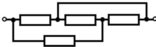
16. Вычислите общее сопротивление цепи, состоящей из одинаковых резисторов  $R_0 = 8 \text{ Ом}$  (см. рис.).
