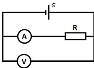
10. Чтобы измерить сопротивление проводника, его включают в схему, содержащую источник тока с Э.Д.С. = 10 В, амперметр сопротивлением  $R_A = 0,05 \text{ Ом}$  и вольтметр сопротивлением  $R_V = 20 \text{ Ом}$  (рис). Показания амперметра  $I_A = 90 \text{ мА}$ , показания вольтметра  $U_V = 5 \text{ В}$ . Вычислите сопротивление исследуемого проводника.
