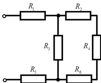
13. При подаче на вход электрической цепи напряжения  $U_1 = 100 \text{ В}$ , напряжение на выходе будет составлять  $U_2 = 40 \text{ В}$ , при этом через резистор  $R_2$  пойдет ток  $I_2 = 1 \text{ А}$ . Если же на выход этой же цепи подать напряжение  $U'_2 = 60 \text{ В}$ , то напряжение на входе будет составлять  $U'_1 = 15 \text{ В}$ . Вычислите значения сопротивлений  $R_1, R_2, R_3$ .
