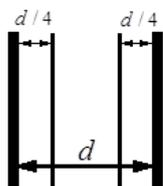
2. В плоский воздушный конденсатор с расстоянием  $d$  между пластинами вводят две тонкие металлические пластины, соединенные проводом (см. рис.). Определить, во сколько раз изменится емкость этого конденсатора.
